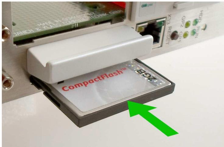
**Achtung:** Die CompactFlash Karte darf nur auf die hier beschriebene Art ohne nennenswerten Kraftaufwand eingesteckt werden! Ein gewaltsames, verdrehtes oder verkanntes Einsetzen beschädigt den CompactFlash-Sockel!
