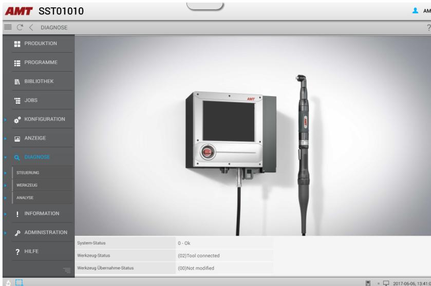
Das Kapitel Diagnose gibt einen Überblick über die wichtigsten Daten von Steuerung und Werkzeug, stellt Testfunktionen für das Werkzeug zur Verfügung und soll sie bei der Fehlersuche unterstützen. Die Diagnose ist in 3 Submenüs gegliedert:
