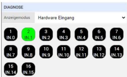
Zusätzlich lässt sich auf die Anzeige der logisch zugeordneten Stecknuss wechseln. In Bezug auf das obige Beispiel müssen die Hardware-Eingänge **IN.0** und **IN.1** beschaltet sein um die logische Stecknuss **IOM\_Socket.1** auszuwählen.
